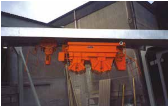
Doppelkammer - Laufwagen für zwei Betonsorten
