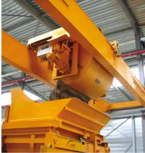
Verteilerkübel in Brücke 25 m
